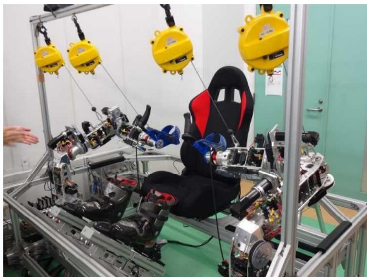
操縦装置（マスター）で双腕のロボット（スレーブ）を遠隔操作するシステムで、こちらも社員の実演のあと、ぼくも操作させていたできました。
